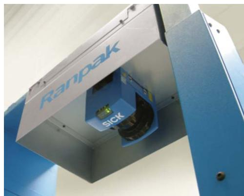
AccuFill は、大量梱包ラインで使用する隙間埋め用紙資材の量を最適化する自動梱包システムです。最大 26 種類のサイズの箱に対応し、1 時間あたり 600 箱に紙資材を投入する処理能力を提供します。ライン上の箱を AccuFill のセンサーがスキャンし、箱のサイズや箱内側の製品体積を測定し、隙間を埋めるために必要な紙資材の量を計算します。その後、FillPak コンバータに情報を送り、必要な量の紙を排出・投入します。作業者は排出された最適量の紙資材で隙間埋めを行うため、資材コスト、梱包作業時間が大幅に削減されます。また、AccuFill は個々の箱データを収集し、すべての梱包作業を分析した詳細な分析レポートを出力できるため、フォローアップ分析を行うことで、梱包作業の効率と生産性を最適化します。
