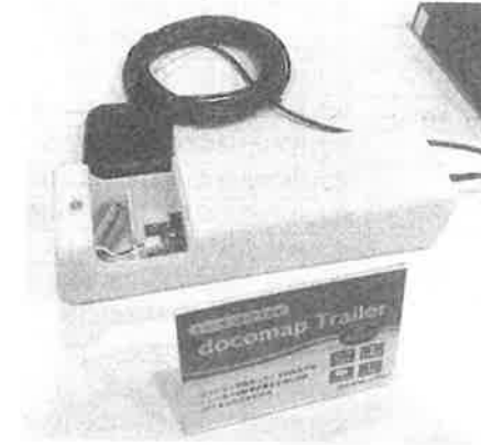
トレーラーに装着する専用の位置測位端末
