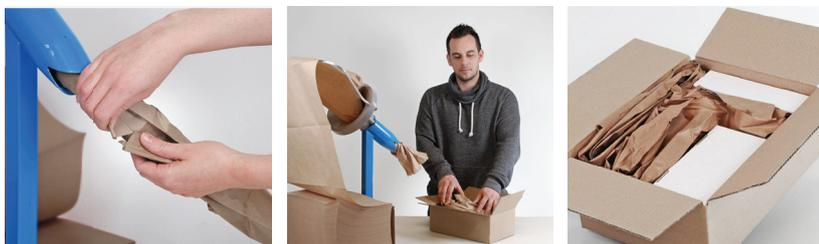
シンプルなデザインのコンバーターで、誰でも輸送中の製品を守る詰め物を一層の紙で効果的に作ることができます。電気は不要で、マニュアルでしわを作って箱に入れる作業から解放されます。折りたたんだ紙のパックは扱いも簡単で載せ換え時間を最小限にし、保管に要するコストも少なくすみます。専用紙は18.6センチ毎にミシン目が入っており、オペレーターが必要な長さの紙を簡単に切り離すことができます。
