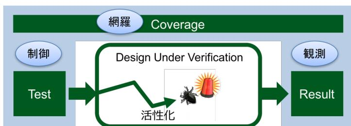
そこで多くのFPGAプロジェクトで採用しているのがアサーションベース検証です。アサーションを検証対象に注入することで観測性が上がり、バグ発生時の不正な振舞いを出力段まで伝搬させる必要がありません。バグが発生したその箇所、その時間でフェイルのメッセージが出力されるため、デバッグの効率化が期待できます。
